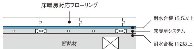
■接着剤（推奨 無垢床ボンド：KOAMB-002 積水フーラー（株）製 ※カタログ190頁をご参照ください。）は、施工要領書に従って周辺部合板及び床暖房器具の小根太上に直径15~20mm、高さ10mm程度を目安として点状に塗布してください。その際、実部分に接着剤が入らないようにしてください。また、接着剤がフローリングの表面に付着した場合は、すぐに布などで拭き取ってください。水性ボンドは、床鳴りや材の膨張の原因となりますので、ご注意ください。
